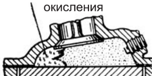
образование очагов холодно- пламенного окисления в несгоревшей рабочей смеси
